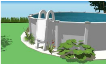
Piscine hors terre avec échelle munie d'une portière de sécurité qui se referme et se verrouille automatiquement.
